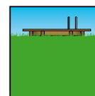
Enterrée sur dalle béton
