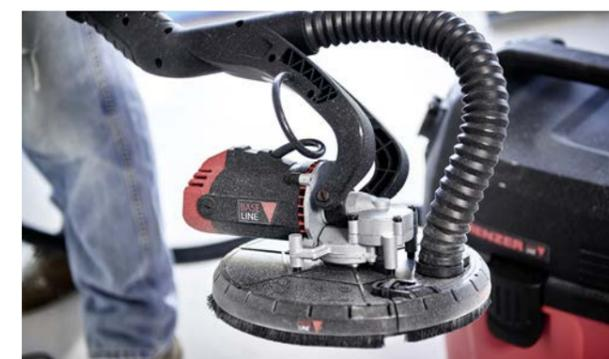
Tête de ponçage flexible pour un ajustement optimal aux murs.
